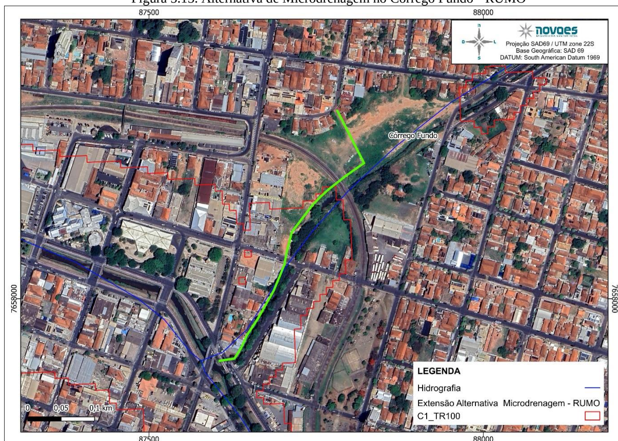
Figura 5.13. Alternativa de Microdrenagem no Córrego Fundo - RUMO
